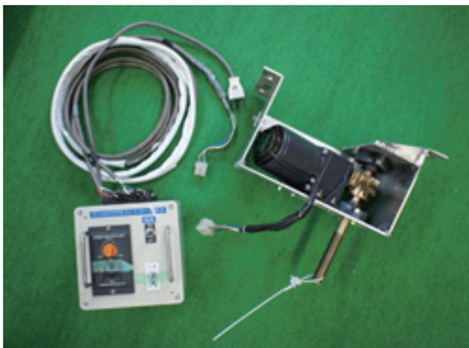
コントローラー（写真右）をACにつないでモーターへ電源供給します。
